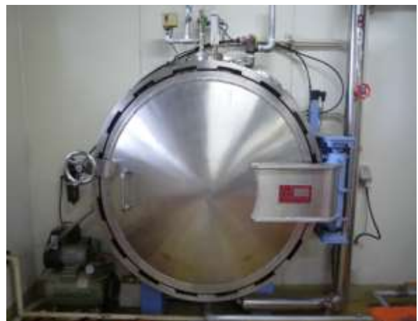
写真2 巨大なオートクレーブ（俗に大釜と言います）
